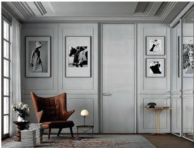
Двери скрытого типа устанавливаются вровень со стеной. Для этого необходим специальный алюминиевый короб, скрытые петли. Полотно при этом может быть шпонированное, окрашенное эмалью, без отделки с грунтованной поверхностью.
