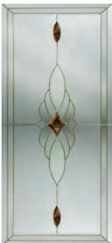
Бевелс (bevels) – витраж изготавливается из стеклянных элементов (фацетов, бевелсов, бевелей) толщиной 5 мм, обработанных по краям фацетированной (снятой под углом) кромкой толщиной 1,5 мм. Бевелсы художественно выкладываются на стекле на специальный клей, упрочненный УФ лучами.
